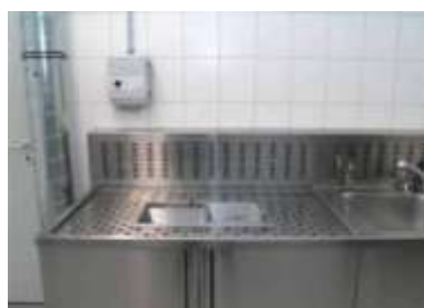
Станция с ситом дополнительно вставленным в рабочую поверхность
